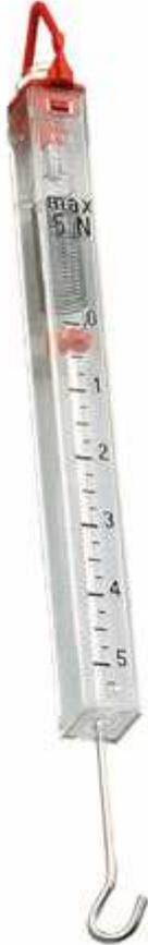
Dynamomètre inaltérable, même utilisé dans l'eau.
