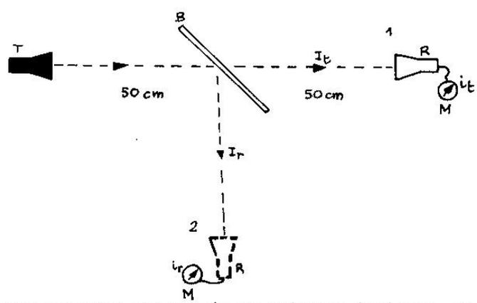
La lame semi-transparente transmet une partie du faisceau incident, et réfléchit l'autre. On peut mesurer  $I_t$  et  $I_r$ .
