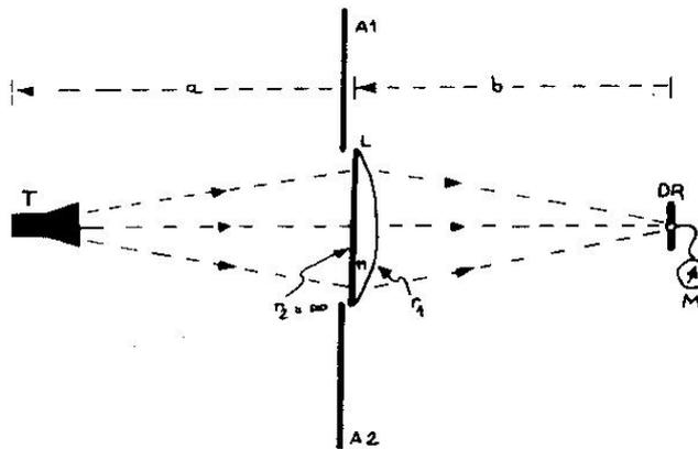
Chercher l'intensité maximum. Mesurer a et b. Calculer la focale de la lentille à partir de l'équation :
