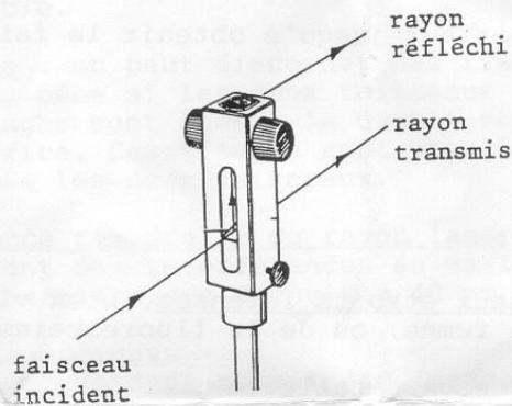
Cet appareil permet de séparer un fin faisceau lumineux en deux faisceaux d'intensité comparable.
