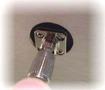
Insérez l'extrémité du cordon dans l'embase femelle. Faire coïncider les ergots en pressant légèrement.
